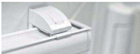
3. Присверлить кронштейн на штапик к плоскости рамы или штапика двумя шурупами 2,9 \*13 (входят в комплект креплений).
