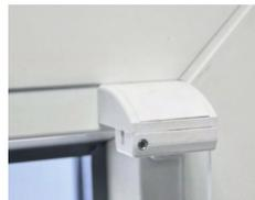
5. При наличии у модели подоконных кронштейнов установить пару кронштейнов на штапик с опорой (правый и левый). Кронштейн присверлить в углу штапика или на раму одним шурупом 2,9\*9,5 и одним 2,9 \*13 (входят в комплект креплений).
